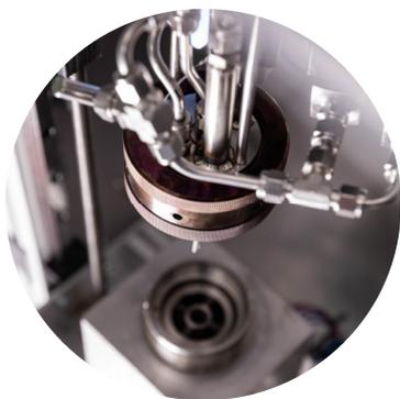
Durch die verfügbaren Destillationsanlagen und Reaktoren sind Verfahrensschritte im Maßstab von 10 Millilitern bis 200 Litern, sowie kontinuierliche Prozesse abbildbar. Dies beinhaltet einfache Batchreaktionen in Rührkesselreaktoren (bspw. Umesterungsreaktionen), bis hin zu neuartigen und komplexen Verfahren, die durch einzelne Grundoperationen abgebildet werden können (bspw. Synthese und Aufreinigung von OME).
